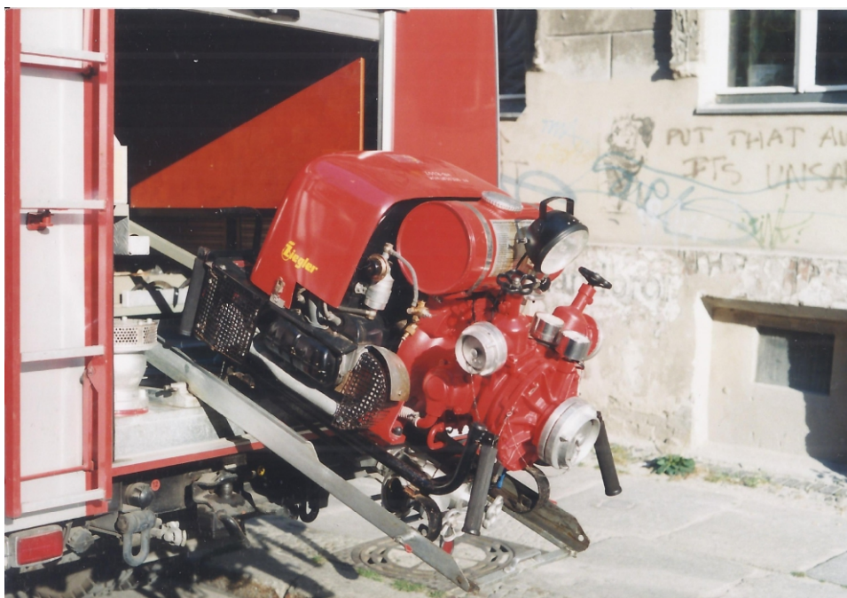
Die im Heck eingeschobene Ziegler Tragkraftspritze TS 8/8 ZS (Typ TS 18/8-2)
