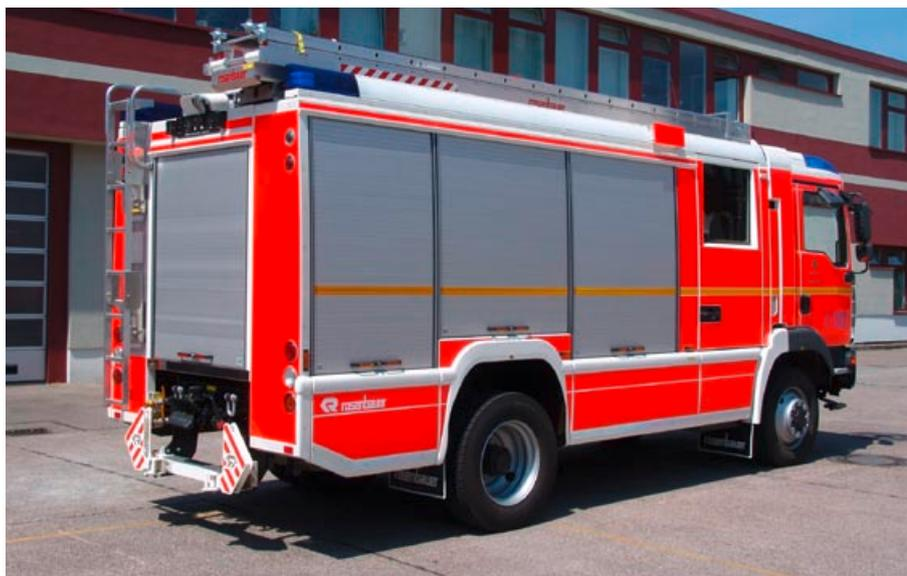
Allrad ein MAN TGM 13.240 Fahrgestell zur Anwendung. Beim Straßenantrieb ist es ein MAN TGL (TGL= leichte Baureihe TGM = mittlere Baureihe). Angetrieben wird das Fahrzeug von einem 6-Zylinder Reihenmotor mit 240 Pferdestärken. Die Kraft wirkt dabei auf ein automatisiertes Schaltgetriebe.
