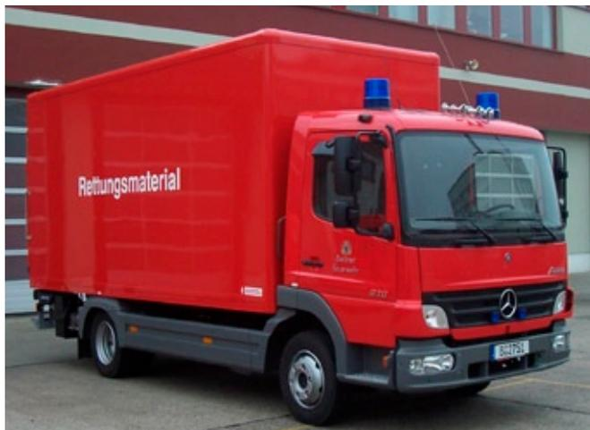
es sich um den Gerätewagen –Rettungsmaterial. Diesmal nicht in der Version eines Abrollbehälters, sondern in Form eines eigenständigen Fahrgestells mit Kofferaufbau. Auch unter dem Aspekt der kommenden Fußball-WM soll damit die Versorgung im Stadtgebiet verbessert werden. Dazu kommt, dass der GW-Rettungsmaterial
