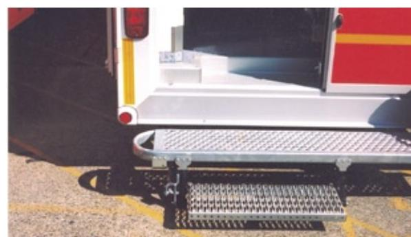
über den Heckausstieg zu entladen. Vereinfacht wird dies mit zweierlei Hilfsmitteln. Zum einen ist das Fahrzeug luftgefedert und kann mittels Schalter pneumatisch abgesenkt werden, des weiteren besitzt der Hecktritt einen elektrischen Zusatztritt, der ein sehr bequemes Einsteigen, auch mit Patienten, ermöglicht. Die Variante ist vielleicht noch etwas gewöhnungsbedürftig, dürfte sich aber dennoch einspielen. Auch im Innenraum ist der Rettungswagen auf den neuesten Stand der Tech-
