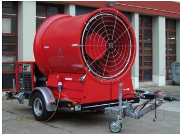
Lange Zeit wurde bei der Berliner Feuerwehr kein Anhängfahrzeug mehr beschafft. Dieser Umstand änderte sich jetzt mit der Indienststellung eines Feuerwehranhängers Ventilator (FwA-Ventilator). Der Einsatzzweck besteht aus der Entrauchung bzw. Belüftung von Tunnelbereichen
