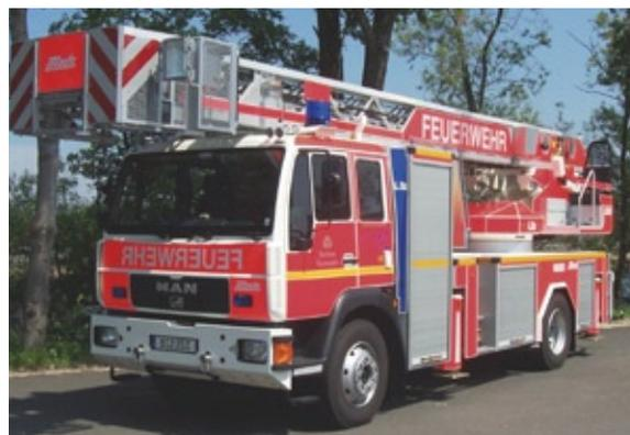
persönliche Schutzausrüstung. Das Fahrerhaus selber fügt sich mittels einer blauen Konturanpassung direkt an den Aufbau an. Um auf eine geforderte schmale Gesamtbreite zu kommen, wurden die Metallstoßfänger gewählt.
