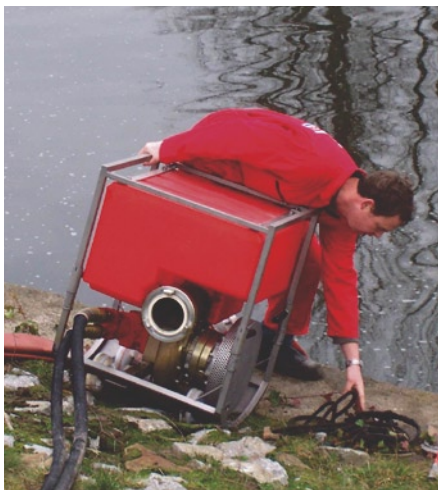
Einlassen der turbinenpumpe
